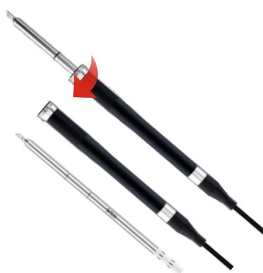
**安装:**将手柄固定帽向右拧松一点,将烙铁头插入手柄焊台自动识别后,将固定帽向左拧紧即可完成安装。
