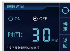
焊笔放置休眠架后，可以设置睡眠时长，该模式下焊笔不加热
