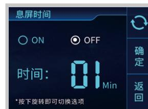
焊笔放置休眠架后，可以设定息屏时间，该模式下lcd背光关闭，焊笔不加热
