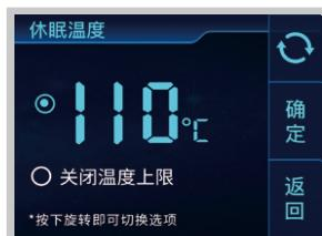
焊笔放置休眠架后，可以设置休眠后的焊笔温度
